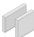
Formålet med filtrene er at fjerne støv og andet snavs fra udeluftten, inden denne blæses ind i huset, og at beskytte varmeveksleren og ventilatorerne mod opbygning af snavs og skidt, som stammer fra boligen.
